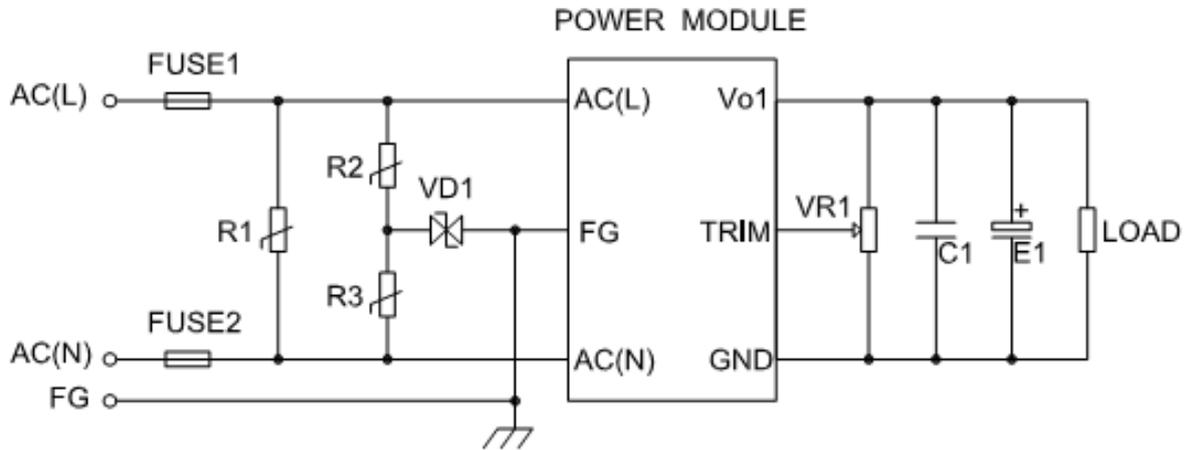
图 1 常规 AC-DC 模块电源基本使用电路图
